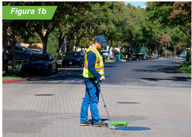
Figura 1. La soluzione Picarro consente di rilevare le perdite in modo efficace, utilizzando sensori montati su veicoli (1a) e successivamente sensori portatili, garantendo una conferma e una riparazione efficiente delle perdite (1b).
