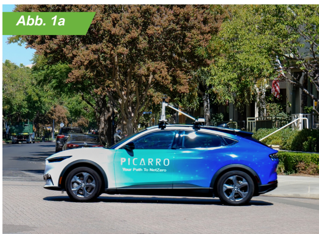
Abbildung 1. Die Lösung von Picarro ermöglicht eine nahtlose Leckerkennung sowohl mit fahrzeugmontierten (1a) als auch mit tragbaren Sensoren und gewährleistet eine effiziente Leckstellenvvalidierung zu Fuß (1b).
