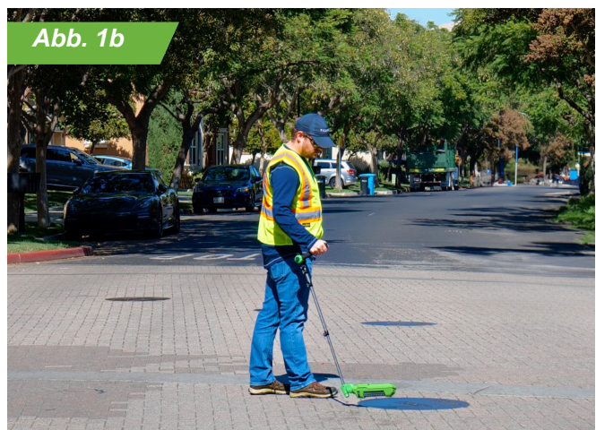
Abbildung 1. Die Lösung von Picarro ermöglicht eine nahtlose Leckerkennung sowohl mit fahrzeugmontierten (1a) als auch mit tragbaren Sensoren und gewährleistet eine effiziente Leckstellenvvalidierung zu Fuß (1b).
