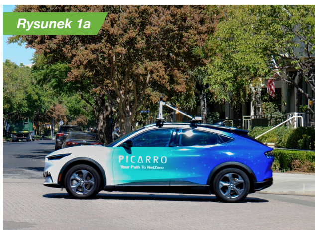
Rysunek 1. Rozwiązanie Picarro umożliwia płynne wykrywanie wycieków zarówno za pomocą czujników montowanych w pojazdach (1a), jak i urządzeń przenośnych, zapewniając skuteczne potwierdzenie i naprawę wycieków podczas inspekcji pieszych (1b).
